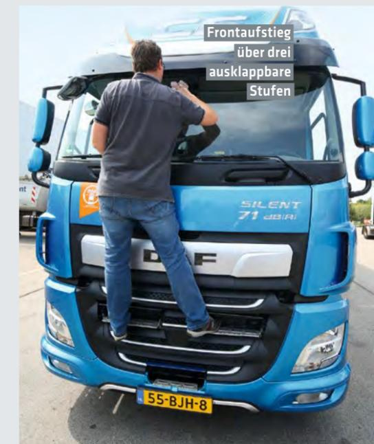
Frontaufstieg über drei ausklappbare Stufen
